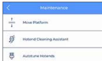
1. **Plattform bewegen:** Diese Funktion wird eingesetzt, wenn es erforderlich ist, die Plattform abzusenken oder anzuheben. Es handelt sich hierbei um einen sehr einfachen Vorgang, der sehr nützlich ist, um die Plattform von den Druckköpfen zu entfernen.
