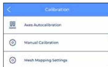
1. **Mesh Mapping:** Mesh Mapping ist ein Kalibrierungsprozess zur Verbesserung der Haftung der ersten Druckschicht.
