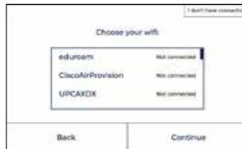
Oben rechts im Bildschirm kann die WLAN-Schnittstelle ausgeschaltet werden. In diesem Fall oder wenn der WLAN-Stick nicht angeschlossen ist, zeigt dieses Menü den folgenden Bildschirm an.
