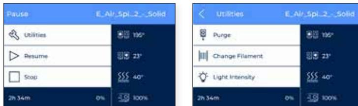
3. **Stopp:** Beendet den laufenden Druck. Der Drucker beendet den Druckauftrag und die Druckköpfe bewegen sich automatisch zurück in ihre Ausgangsposition. Vor Beendigung des Druckauftrags erscheint eine Bestätigungsmeldung auf dem Bildschirm. So wird ausgeschlossen, dass es sich um einen Bedienungsfehler handelt.
