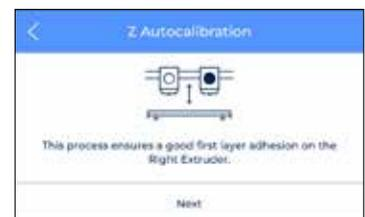
Diese wird als Feineinstellung angesehen und nur für fortgeschrittenen Benutzern empfohlen. Dabei können die X- und Y-Offsets zwischen den beiden Düsen und der Z-Offset der Düse zur Bauplatte justiert werden.
