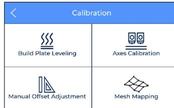
1. **Nivelación de la superficie de impresión:** este proceso garantiza que la placa de impresión esté correctamente plana antes de imprimir. Esta operación es muy fácil de realizar y al mismo tiempo muy importante para lograr buenos resultados. También se incluye en el [Asistente de configuración](#).
