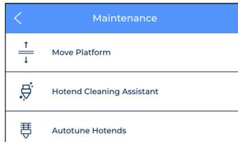
1. **Mover superficie de impresión:** se utiliza cuando es necesario bajar o subir la plataforma. Se trata de una operación muy sencilla y muy útil para separar la plataforma de los cabezales de impresión.
